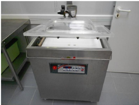
Machine à emballage sous vide ou sous atmosphère modifiée SAMMIC type V640
